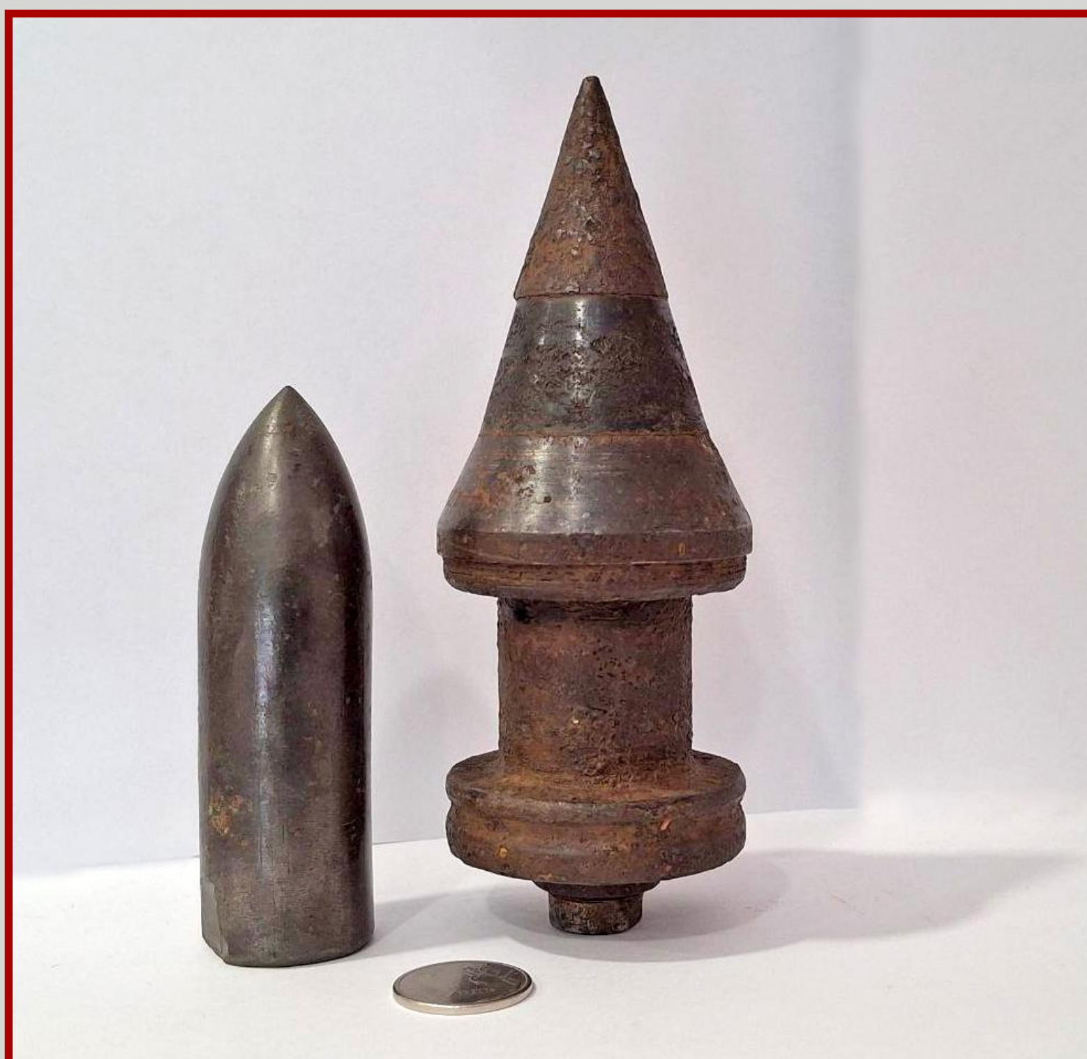
Немецкий 50 мм подкалиберный снаряд и сердечник из карбида вольфрама.
